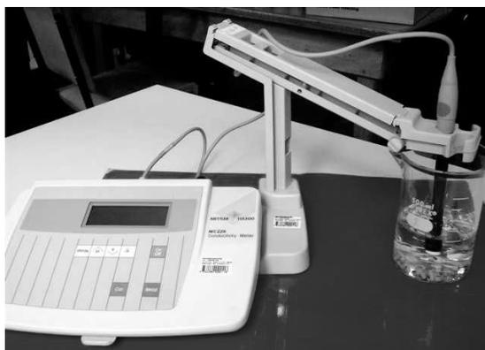
**Fig. 10.7.** Medición de CE en semillas de soja utilizando un conductímetro de mesa.
