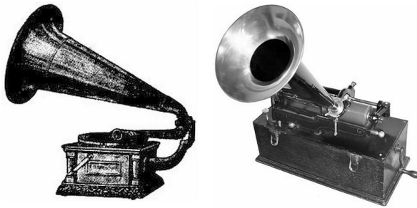
84. Gramófono basado en disco (izquierda) y fonógrafo basado en cilindro (derecha).
