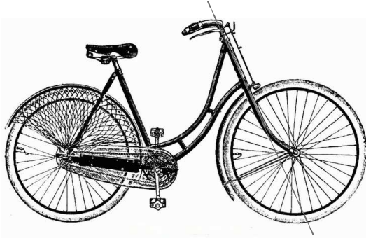
56. Bicicleta de dama, 1900. La línea punteada indica el eje de rotación del volante.
