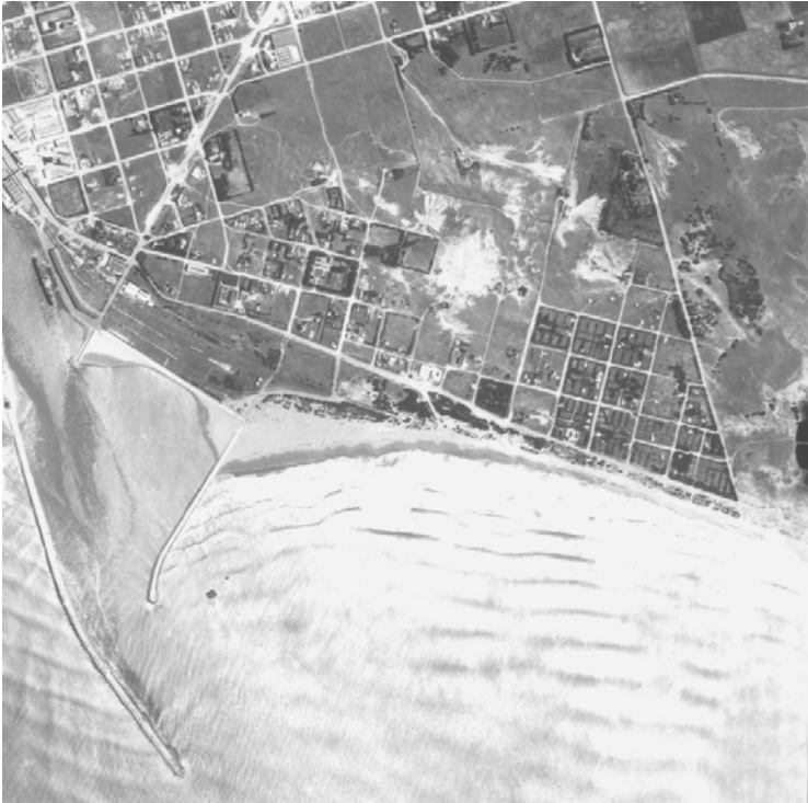
Fig. 8. A) Puerto Quequén y Bahía de los Vientos (Necochea), año 1964. En el centro de la fotografía se aprecian rasgos de extracción de arena. La playa tiene una geometría asimétrica por el efecto de reparo de las escolleras del puerto. Los médanos están vegetados y/o forestados. B) Médanos vegetados en Bahía de los Vientos, año 2007. A pocos cientos de metros hacia el Oeste está emplazado el Puerto de Quequén. Ya han sido fijados los médanos mediante tamariscos y uñas de gato. Hacia la izquierda se aprecian las huellas dejadas por los peatones y las motos que eliminan la cubierta vegetal y liberan la “arena voladora”. Inclusive pueden formarse sopladeros (blowout).
